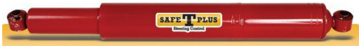
圖 22 大型車爆胎防滑器
