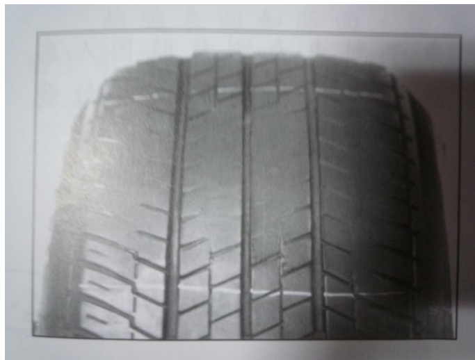
圖 18 後傾角示意圖與可能造成的異常磨耗
