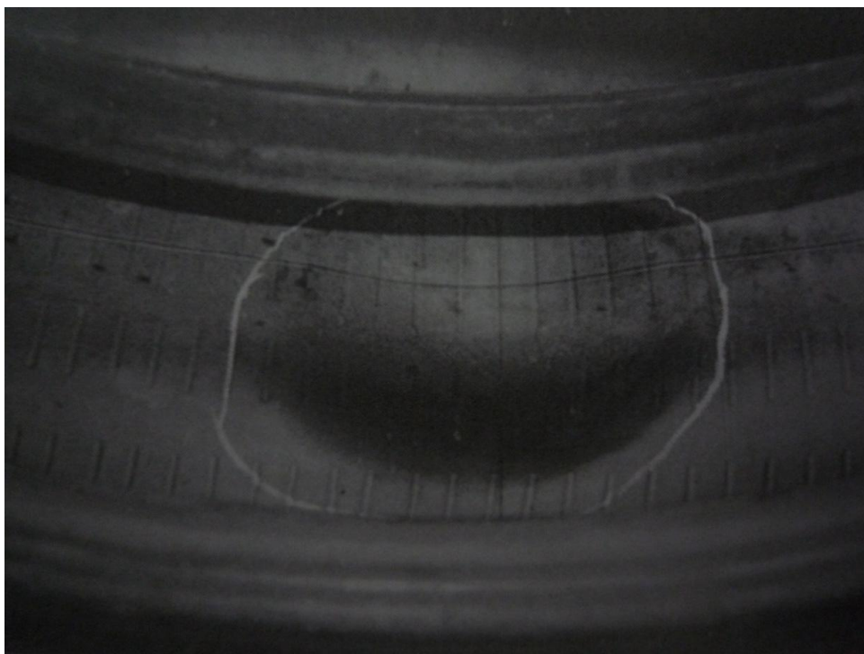
圖 15 胎面與內部分離
